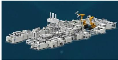
验，能为液流电池提供系列设备及自动化解决方案，实现交钥匙工程。公司自研液流电池智能产线由板框预装线和电堆堆叠线组成，板框预装线包含盖板点胶及检测、极板激光焊接及检测、极板密封线点胶及检测、极板激光焊接，电堆堆叠线包含组件来料预处理、电堆叠叠度检测、电堆压合及螺栓组装、电堆自动下料。
