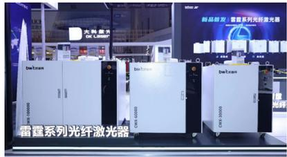
从测试数据来看，采用 CTC 一体化技术的雷霆系列 12kW 光纤激光器，整机尺寸缩小了 70%，但是在碳钢切割效率方面反而最高提升了 40%，既能保证薄板切割速度也能兼顾中厚板切割效果。雷霆高亮度 20kW 光纤激光器采用 75μm 芯径，平均能量密度更高，空气碳钢切割效率最高提升 76%，进一步节省用户运营成本。在厚板切割应用领域，雷霆 60kW 光纤激光器相对传统等离子加工工艺，效率翻了 3 倍，将进一步加速光纤激光器的应用替代，在船舶制造、建筑钢材、机械加工、能源电力等高端制造领域具有非常大的应用潜力，助力制造
