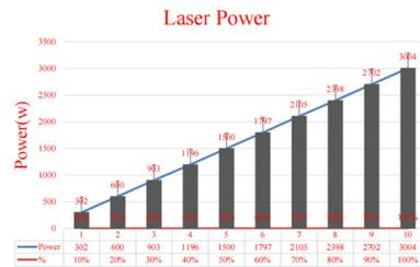
通过采用全新的设计理念，杰普特新一代 3000W 小体积单模块激光器性能表现更加优异，其模拟量出光响应延时小于 50 μs，使能及调制信号出光响应延时小于 10 μs，更快的响应速度，在高速高频等特殊应用场景适应性更高。此外，新版产品功能更加全面，可通过外控线及网口两种方式进行功率反馈，便于监控机器工作状态。且出光功率 1%~100% 范围可调，功率 10% 以下可正常出光。满足小功率应用场景需要，实现一机多用。首尾能量缓慢降可通过上位机自由调节，进一步满足更多的应用场景。同时，激光器对实际出光时间进行监控显示，便于计算实际生产效率，进一步提升用户使用体验。
